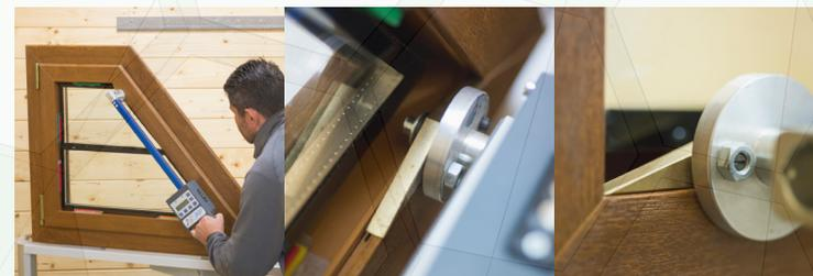
**DigiBAR 4.0** è uno strumento di misura elettronico pensato e realizzato per prendere misure di fermavetro. È composto da un estruso in alluminio sul quale scorre un cursore plastico contenente l'elettronica e le batterie. **DigiBAR 4.0** può misurare tra i 140 e i 1600mm con precisione di 0,1 mm e può arrivare fino a 3000 mm installando la barra di estensione.
